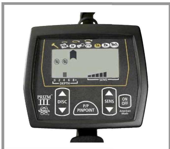
1. Кнопка ON/OFF включает и выключает питание прибора. При разрядке батарей в левой части дисплея автоматически появляется предупреждение LOW BATT. Замените батареи двумя новыми 9-вольтовыми щелочными батареями. Если прибор не собираетесь использовать в течение более 2 недель, рекомендуется вынуть из него батареи.
