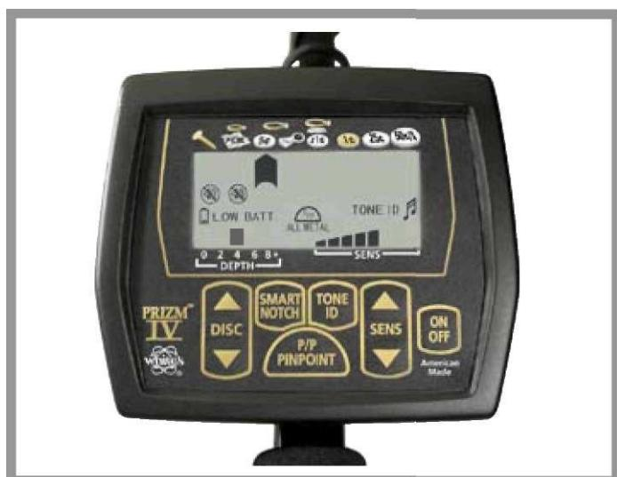
1. В верхней части дисплея перечислены восемь категорий объектов и показаны наиболее типичные металлы, характерные для этих объектов. Следует иметь в виду, что к
